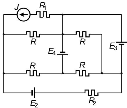
**4.** U kolu, prikazanom šemom na slici, odrediti snage svih generatora. Numerički podaci:
