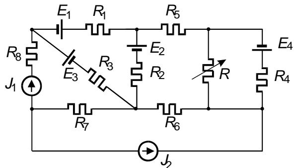
**3.** U kolu, prikazanom šemom na slici, poznate su vrednosti svih elemenata, dok je otpornik  $R$  promenljiv. Odrediti snagu generatora  $E_4$  u funkciji otpornosti otpornika  $R$ . Numerički podaci:
