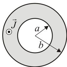
3. Кроз неограничено дуг прав проводник у облику цеви, популупречника унутрашњег зида  $a = 2\text{ mm}$  и спољашњег  $b = 4\text{ mm}$ , противе једносмерна струја сталне густине  $J = 6 \cdot 10^6 \text{ A/m}^2$ . Проводник је начињен од бакра ( $\mu \approx \mu_0$ ) и налази се у вакууму. Одредити интензитет вектора магнетне индукције  $B$  у функцији растојања  $r$  од осе проводника и израчунати његову вредност на растојањима  $r = a$  и  $r = b$ .
