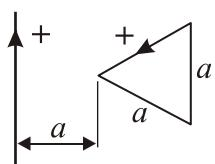
2. Проводна контура у облику једнакостраног троугла налази се у истој равни са неограничено дугим проводником. Систем се налази у вакууму. Димензије контуре и њен положај, као и позитивне оријентације контуре и проводника приказани су на слици. Одредити коефицијент међусобне индуктивности неограниченог проводника и контуре ако је  $a = 10\text{ cm}$ .
