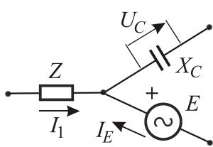
6. У делу електричног кола, приказаном шемом на слици, познате су ефективне вредности струје кроз импедансу  $Z$ ,  $I_1 = 0.2\text{ A}$ , и напона на кондензатору  $C$ ,  $U_C = 20\text{ V}$ . Напон  $U_C$  фазно заостаје за струјом  $I_1$  за  $\pi/6$ , док је реактанса кондензатора  $X_C = 100\Omega$ . Одредити ефективну вредност струје  $I_E$  кроз генератор.
