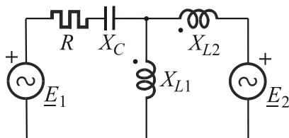
5. У колу, приказаном шемом на слици, одредити комплексне снаге на свим елементима кола. Нумерички подаци:  $E_1 = 1V$ ,  $E_2 = (-2 + j)V$ ,  $X_{L1} = X_{L2} = X_C = R = 2\Omega$ ,  $k = 0.5$ .
